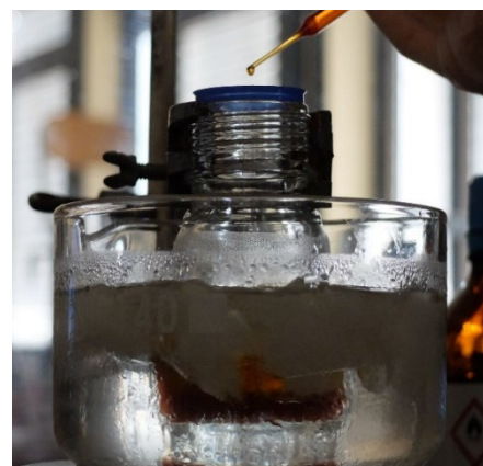
Abb. 16: Heptan-Brom-Lösung wird tropfenweise zu Lycopin gegeben
