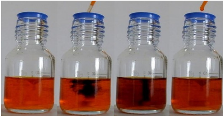
Abb. 19: Tropfenweise Zugabe von Brom-Heptan
