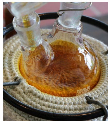
Abb. 13: Lycopin-Lösung in der Destillationsapparatur
